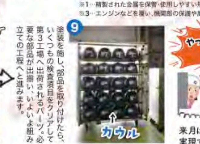
塗装を施し、部品を取り付けたら、いくつもの検査項目をクリアして第3工場へ出荷されるパーツ。必要な部品が出荷され、いよいよ組み立ての工程へと進みます。
