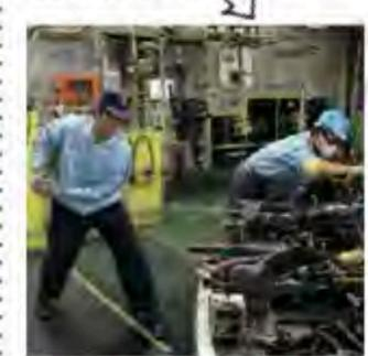
今回、特別に検査の様子を近くで見せていただきました! こちらは、丸い水槽に入れて実際に動作試験をしています。YKPでは、すべての船外機を検査する「全数検査」を採用しています。「何も無い海の上で突然動かない! なんてことになっては大変でしょう」と川口さん。この徹底した検査が、世界トップシェアの信頼へと繋がっているのですね。
