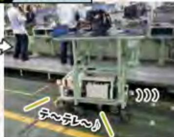
だ、台車がひとりでに走っている!? しかも軽快な音楽と共に…! (「ドラクエのメインテーマ」よく見ると台車の下に自走ロボットが! 別の場所からエンジンを運ぶ台車を持ってきました。エンジンを次工程に配達した後、空台車を返却するために元の場所へ戻っていきました。
